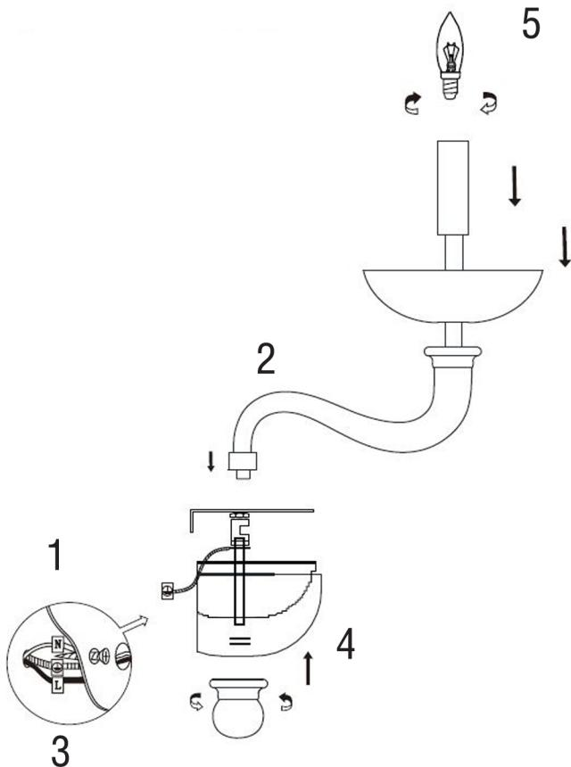
1. Просверлить ударной дрелью в стене отверстия для пластиковых дюбелей. Вставить пластиковые дюбели в просверленные отверстия. Привернуть с помощью саморезов основание бра.
